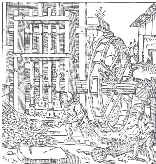
Rys. 73. Ryciny przedstawiają pracę koła wodnego.
